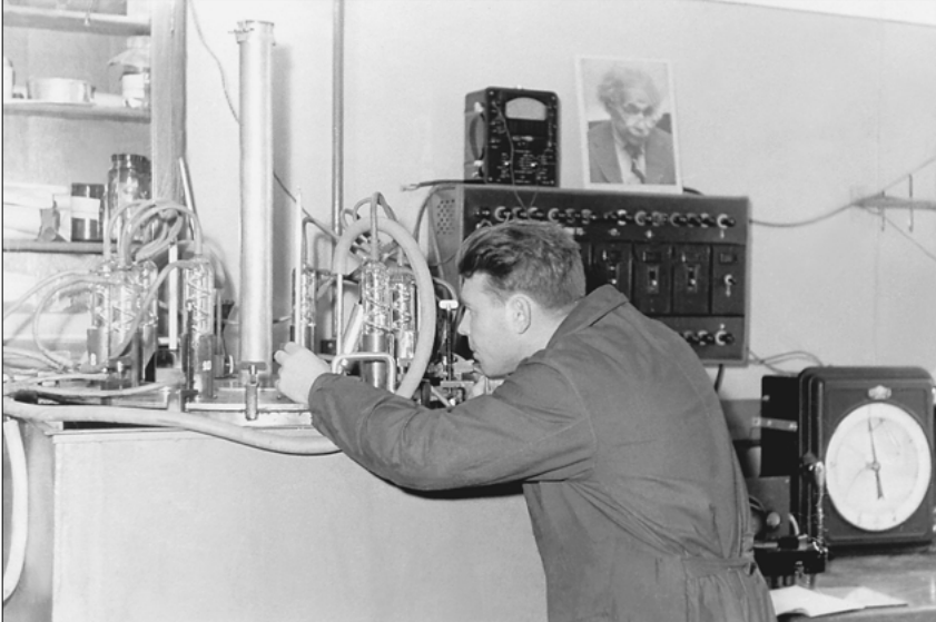
У действующего макета установки для приготовления пластических сцинтилляторов – прототипа заводской установки УППС
