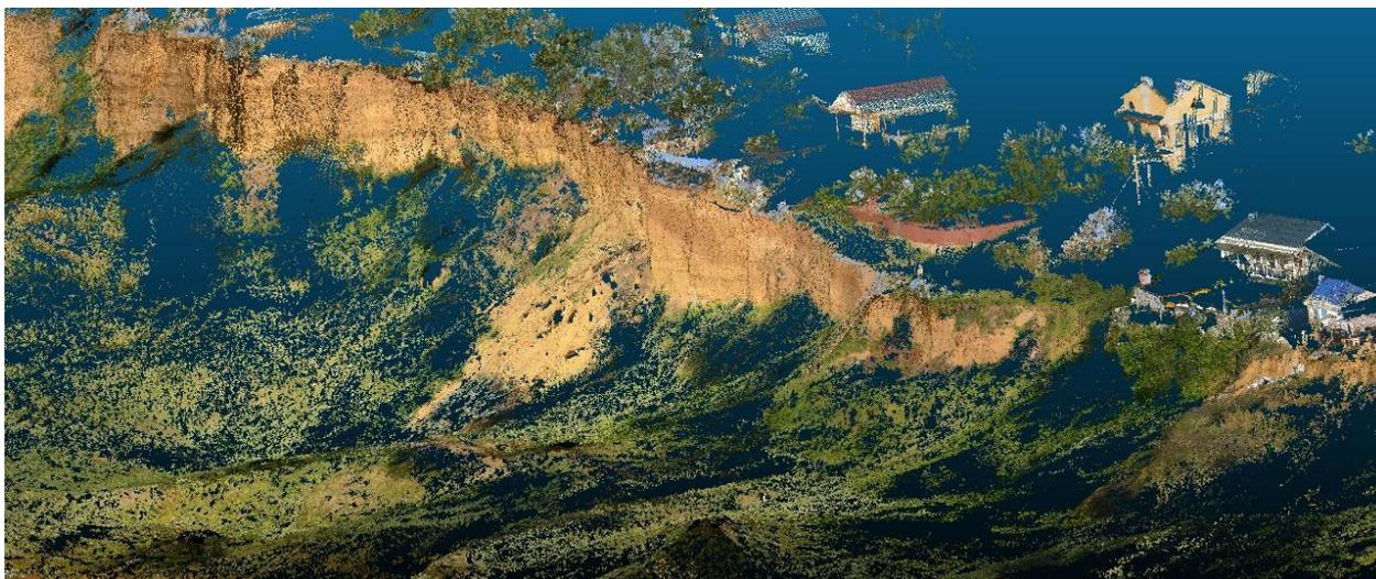
Рис. 5. Цифровая модель обвально-оползневых склонов в районе пляжа Учкучевка
