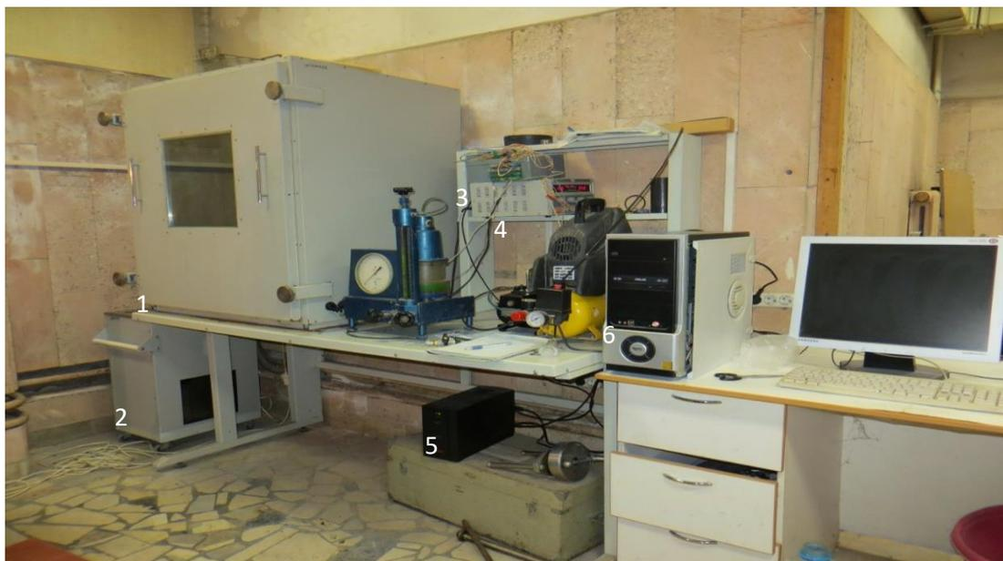
Рисунок 1. Общий вид термокамеры с записью параметров опыта на компьютер (1 – термокамера суховоздушная; 2 – термостат; 3 – блок регистрации; 4 – блок питания; 5– источник бесперебойного питания; 6 – компьютер).
